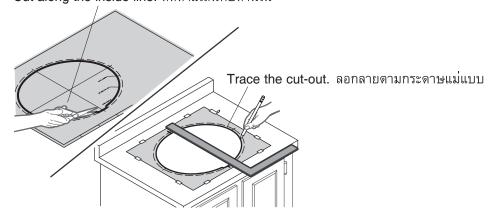
2 Drill pilot hole and cut the countertop opening. เจาะรู แล้วตัดตามรอยบนเคาน์เตอร์
